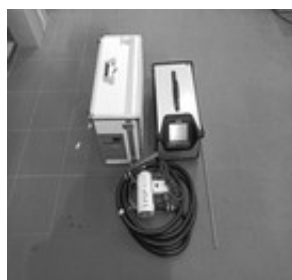
Multigas analizator HORIBA PG350
