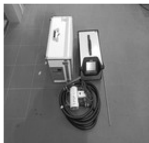
Multigas analizator HORIBA PG350
